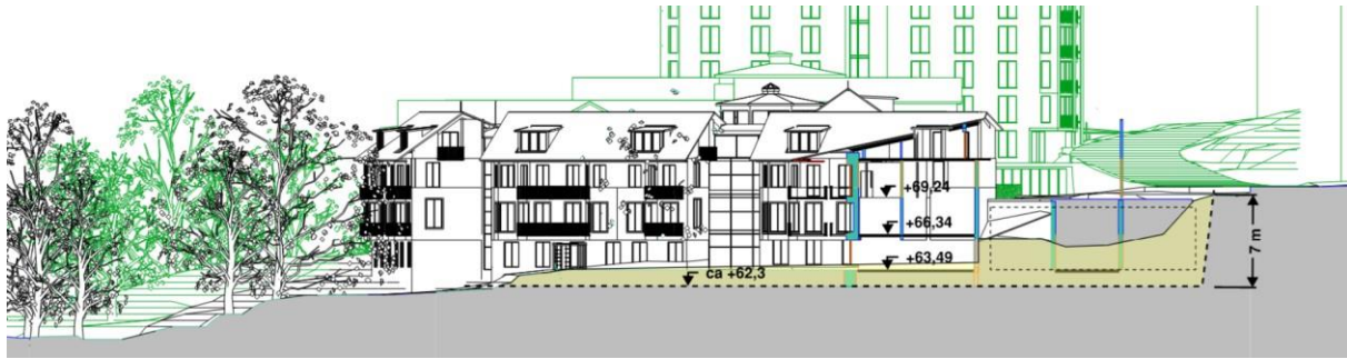
Figur 6 Ovanstående bild visar sektion 1-1 genom norra delen av planerad tillbyggnad. Slänt mot Chalmers teknikpark åt vänster i figuren och anslutning mot Doktor Allards gata åt höger i figuren. Gulmarkerad yta illustrerar jord- och bergschakt under byggskedet.
